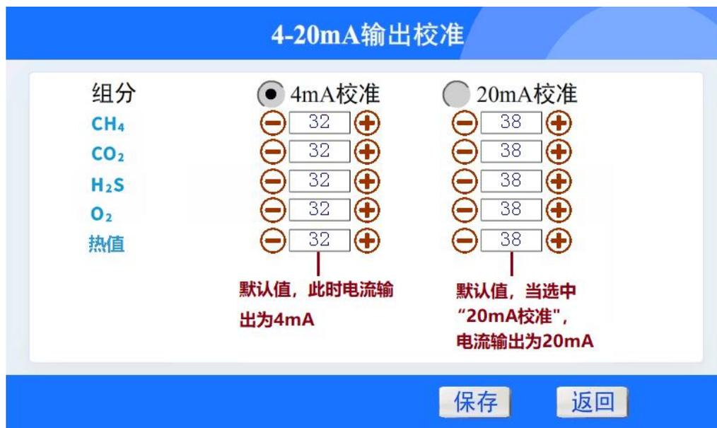
进入界面，按钮为单项切换，默认按钮【4mA 校准】，电流输出为 4mA,通过【加减】按钮作调节，20mA 校准按钮失效；切换到【20mA 校准】时，4mA 校准按钮失效，电流输出为 20mA，通过【加减】按钮作调节；【保存】即保存调节值，点击【返回】按钮，回系统设置界面。
