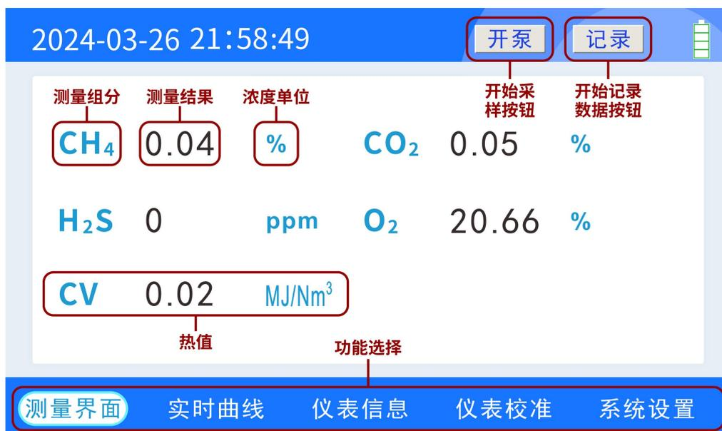
如上图所示，当前界面为“测量界面”，实时显示相应的组分测量结果。点击下部分栏标识文字即可进入相应分栏进行相关操作。
