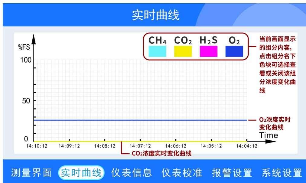
当前界面为“实时曲线”界面。曲线颜色和组分名称下的按钮颜色相对应。例如，“CO”浓度变化曲线为图中“黄”线，“O<sub>2</sub>”浓度变化曲线为图中“蓝”线。横坐标为s秒，纵坐标最大值为各组分量程，曲线依照（浓度/量程）的比例显示。
