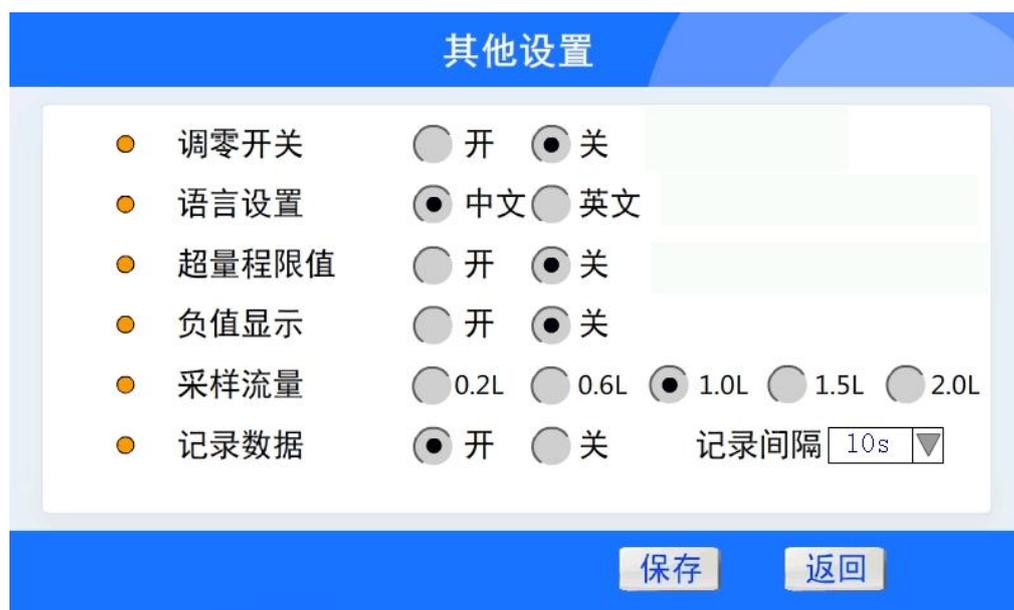
【超量程限制】开，【测量界面】显示的最大值为量程的百分比，【超量程限制】关，超量程额度选项隐藏，【测量界面】正常显示；超量程后，【测量界面】浓度字体变红色；
